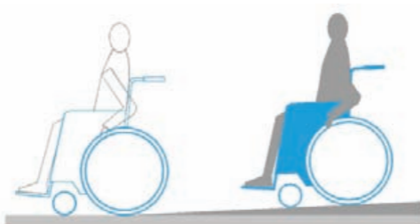
Final de la rampa nivelada a piso
